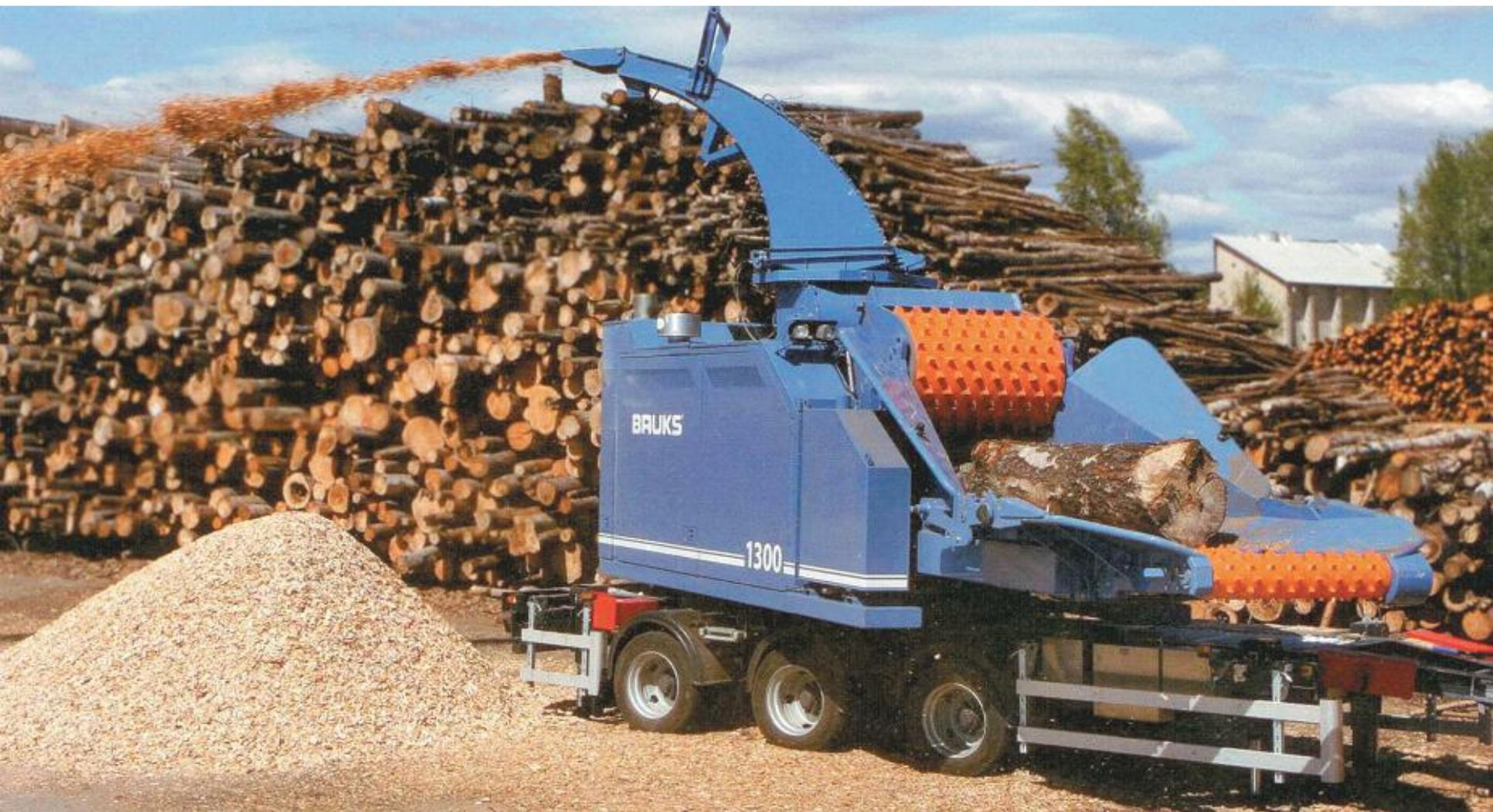
Барабанные рубительные машины не так чувствительны к неоднородности состава сырья, поэтому они также могут применяться для переработки лесосечных отходов.
