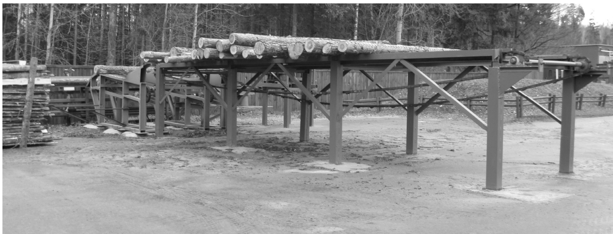
Рис. 2. Механизм поштучной подачи на месте установки
