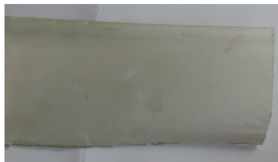
Рис. 4. Препрег на основе стеклоткани Т10-80 и полипропилена
