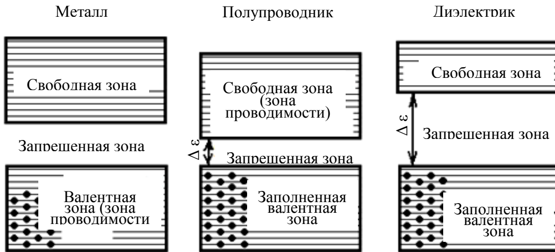
Рис. 1.15. Модель строения твердых тел в соответствии с зонной теорией проводимости
