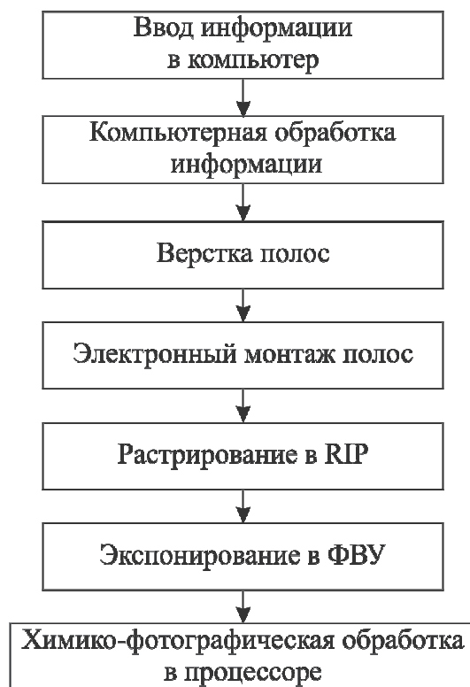
Рис. 4.2. Схема изготовления ФФ по технологии CtF
