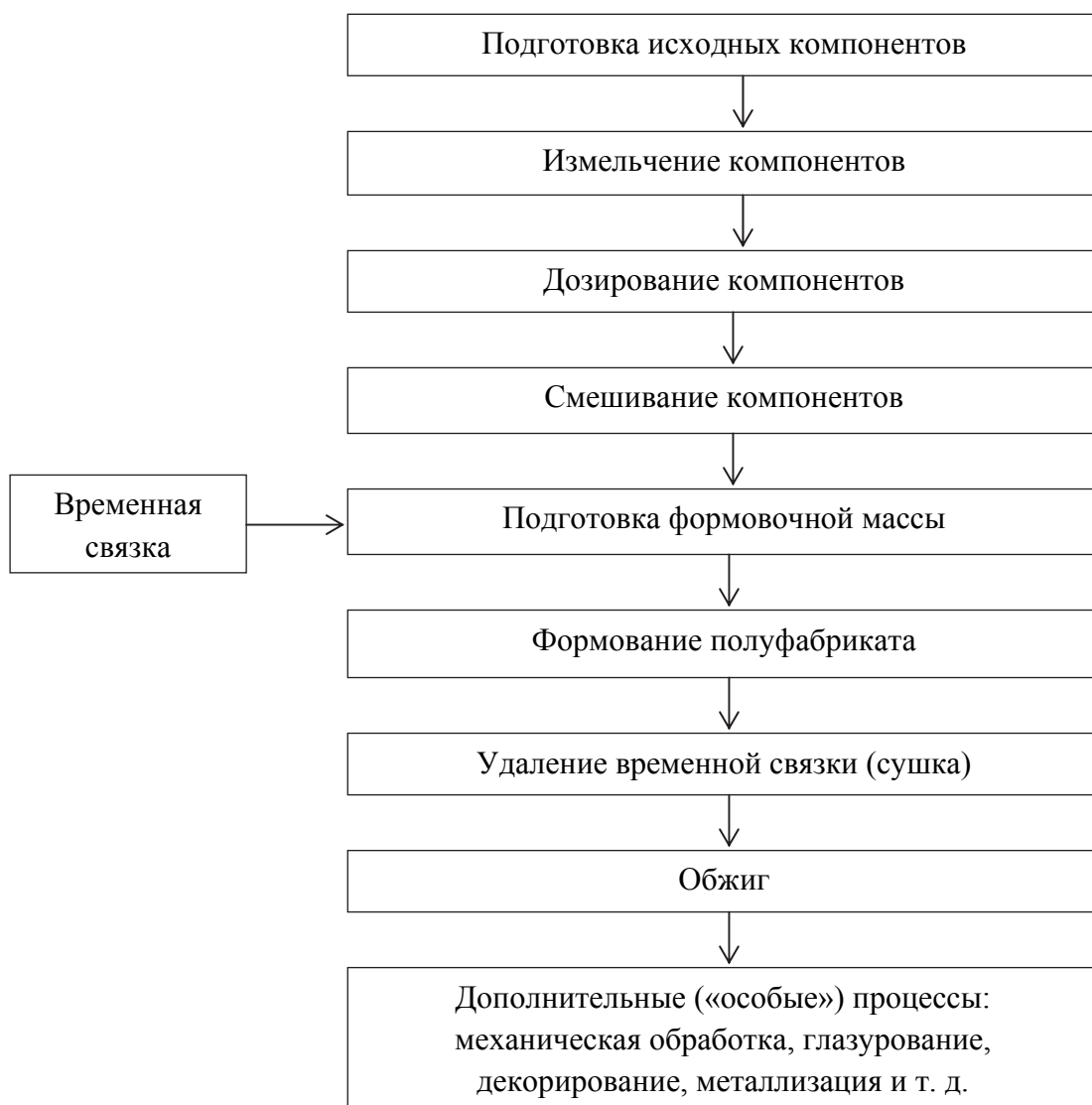
Рис. 16. Последовательность основных стадий керамической технологии
