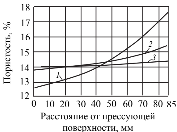
Рис. 30. Распределение пористости по высоте:
