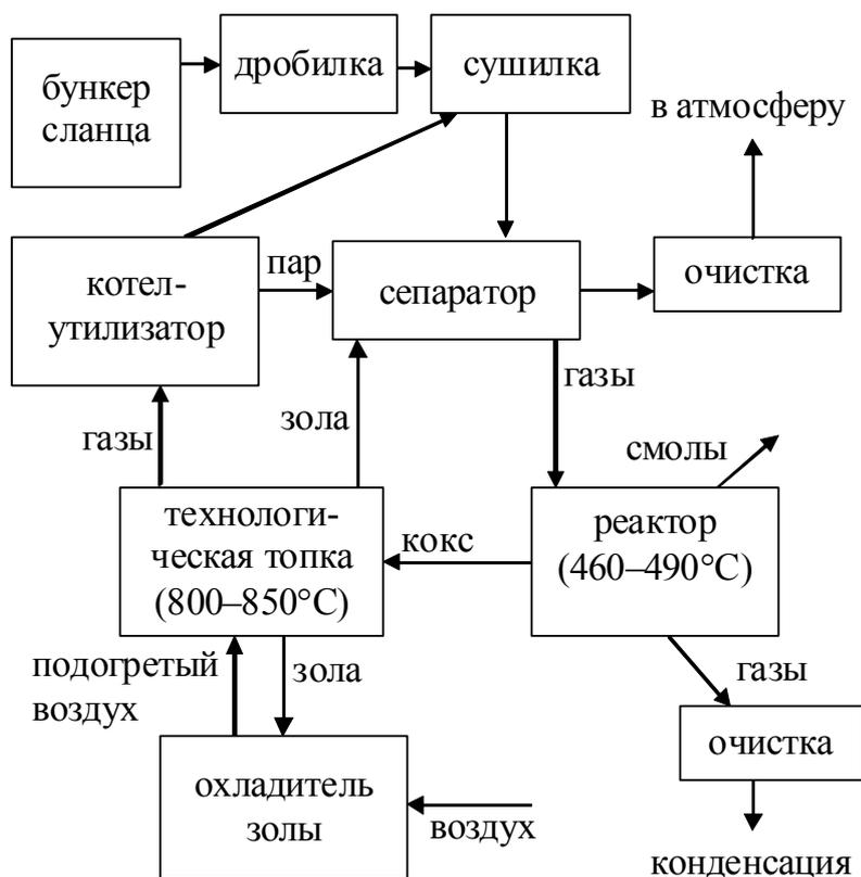
Рис. 2.22. Технологическая схема установки термического разложения сланца
