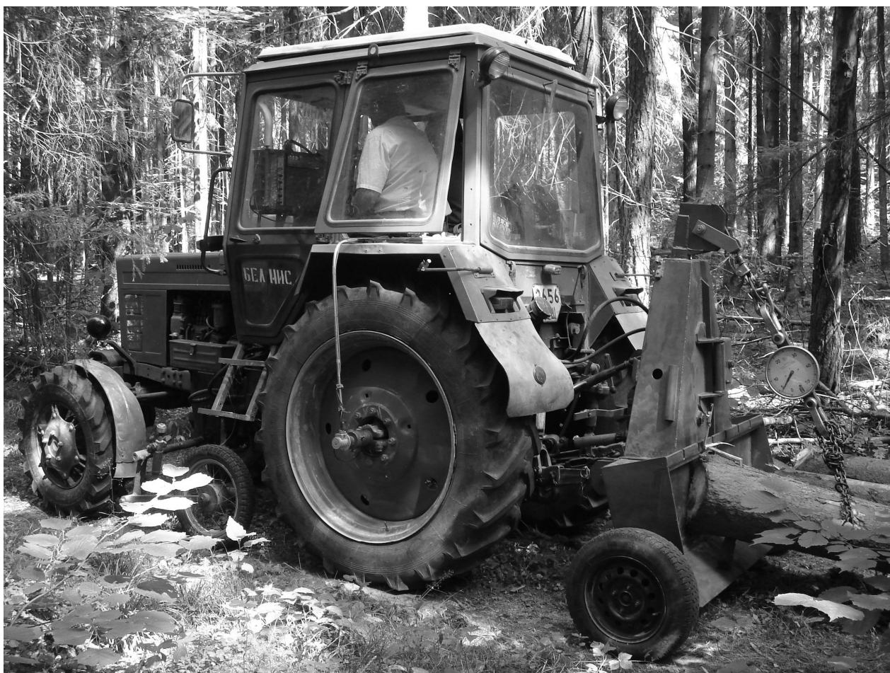
Рис. 1. Трелевочный трактор ТТР-401 с технологическим оборудованием с усовершенствованной конструкцией несущей системы
