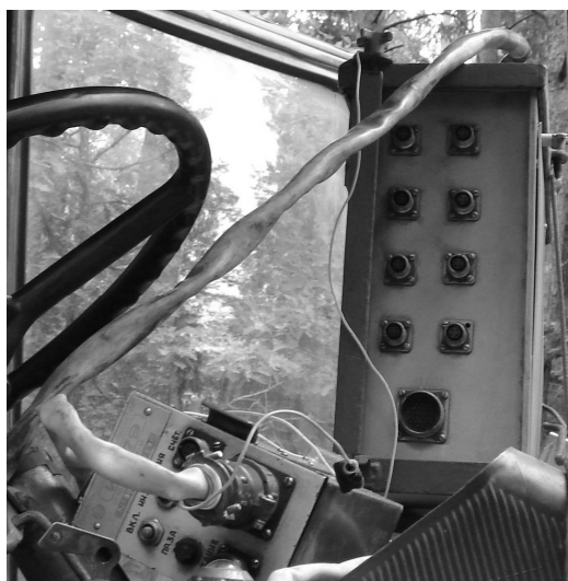
Рис. 2. Места установки счетчика расхода топлива ИП-179 на ТТР-401
