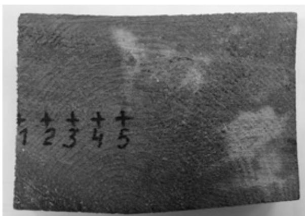
Рис. 3. Образец шпалы, пропитанной биозащитным раствором на основе антисептика Tanalith E 3492 на ОАО «Борисовский шпало-пропиточный завод» для определения содержания меди
