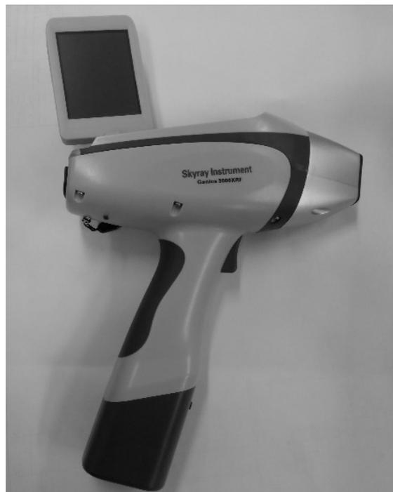
Рис. 1. Портативный энергодисперсионный рентгенофлуорисцентный спектрометр Genius 3000
