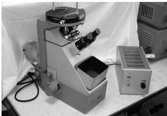
Рис. 4. Металлографический микроскоп ММР-4
