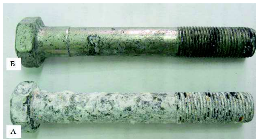
Рисунок 5 – Поверхность образцов с диффузионным цинковым слоем (А) и электролитическим цинковым покрытием (Б) после 240 часов испытаний в камере соляного тумана
