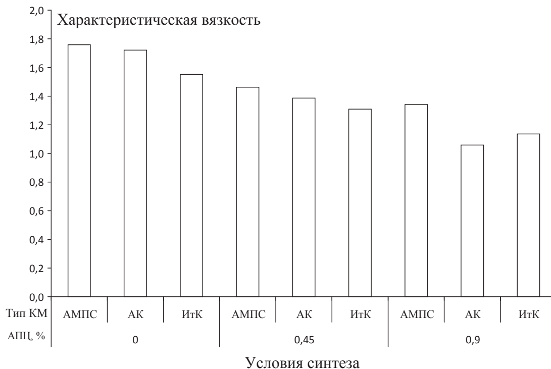
Рисунок 4 – Зависимость характеристической вязкости поли[АН(91)-со-МА(8)-со-КМ(1)] от содержания АПЦ
