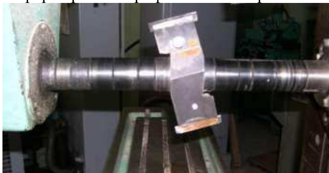
Рисунок – Фиксация опытной фрезы на посадочном валу
