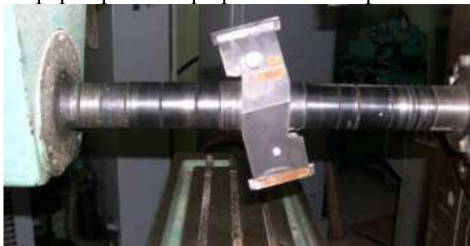
Рисунок – Фиксация опытной фрезы на посадочном валу
