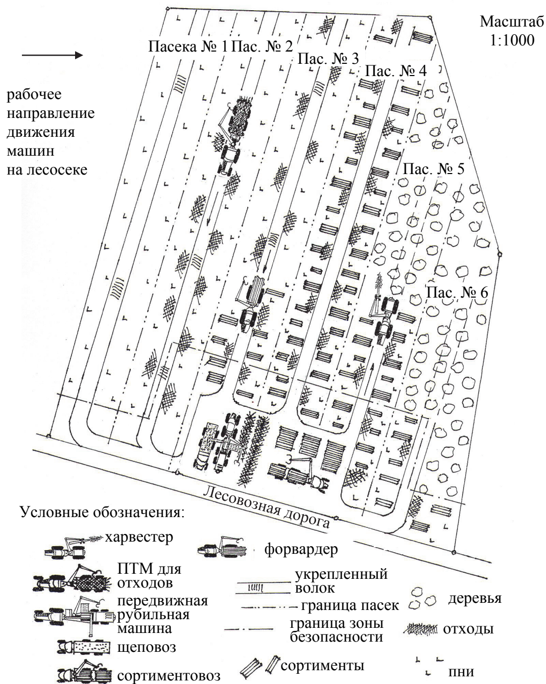
Рис. 10.3. Технологическая схема заготовки сортиментов системой машин «харвестер и форвардер» и топливной щепы на верхнем складе мобильной рубильной машиной
