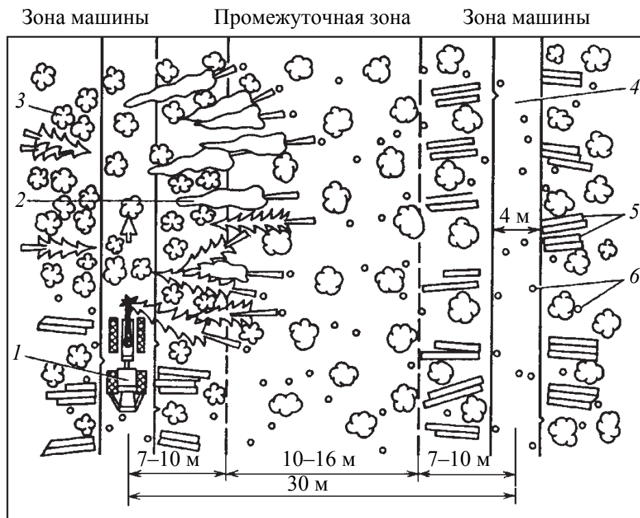
Рис. 6.2. Схема разработки лесосеки харвестером при полумеханизированном методе: 1 – харвестер; 2 – поваленные бензопилой деревья; 3 – растущий лес; 4 – волок; 5 – сортименты; 6 – пни
