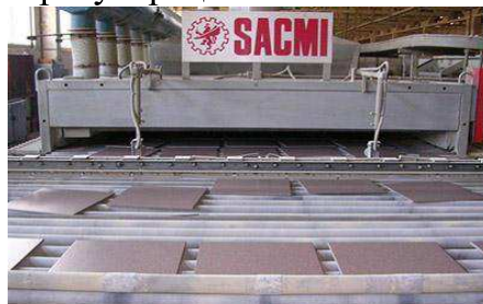
а) печь обжига фарфоровых изделий, б) фритт варочная печь, в) печь приготовления плиты. Рисунок 1 – Источники тепловых ВЭР на ОАО «Керамин»
