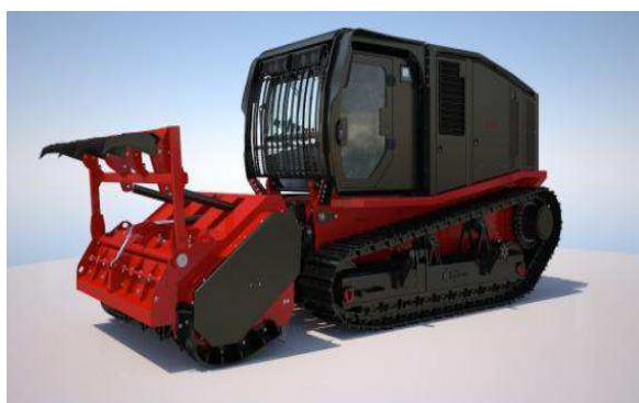
Рисунок 1 – Мульчер на гусеничном шасси
