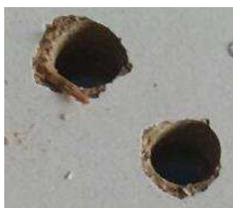
Рисунок 1. Дефект обработки сверлением
