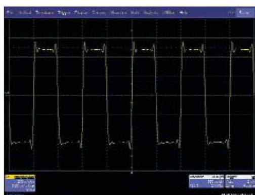
Рисунок 7 – Интерполяция \sin x/x , частоте дискретизации – 25 МГц, входной сигнал меандр с частотой 1
