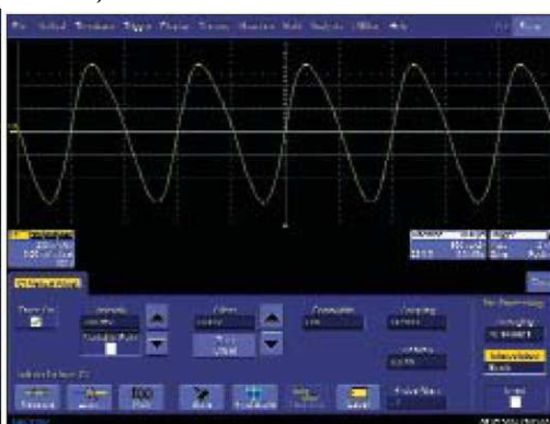
Рисунок 4 – Интерполяция \sin x/x , частота дискретизации – 5 МГц, входной сигнал – меандр с частотой 1 МГц
