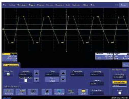
Рисунок 3 – Интерполяция линейная, частота дискретизации – 5 МГц, входной сигнал – меандр с частотой 1 МГц
