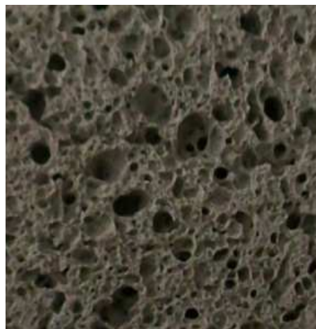
Рисунок 2 - Пеносиликат для изготовления теплоизоляционных материалов (температура вспучивания 650°С, время выдержки 30 мин)
