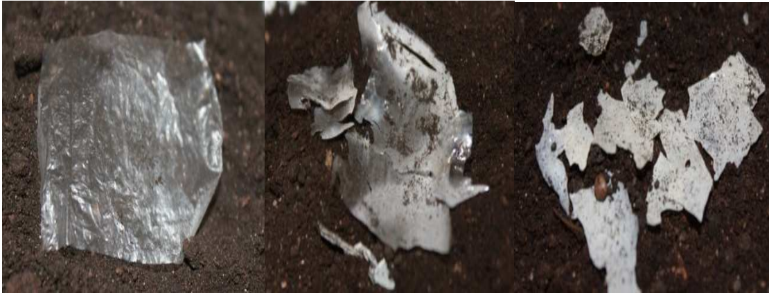
Рисунок – Внешний вид пленок на основе полиэтилена (а), полилактида с M_n \approx 60\ 000 Да (б) и полилактида с M_n \approx 30\ 000 Да (в) после пребывания в почве в течении одного года
