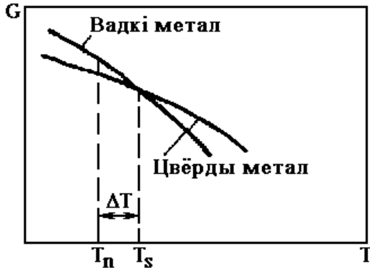
Мал. 12. Змяненне тэрмадынамічнага патэнцыялу ў залежнасці ад тэмпературы для металу ў цвёрдым і вадкім станах
