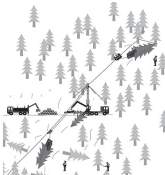
Рисунок 2 – Схема работы канатной установки
