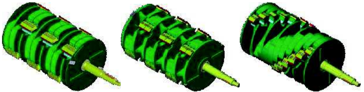
а) ротор закрытого типа. б) ротор открытого типа в) ротор спирального типа
