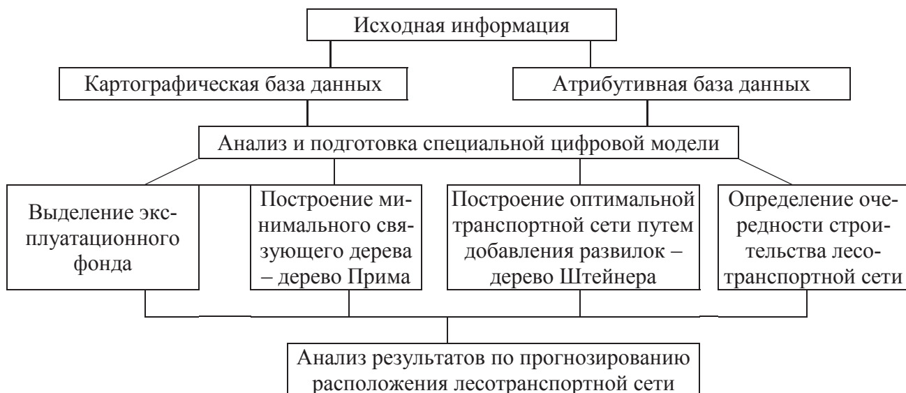
Рисунок 1 – Структурная схема по прогнозированию расположения лесотранспортной сети
