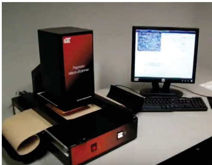
Рисунок 5 –Микросканер для определения сорности бумаги фирмы OpTestEquipmentInc
