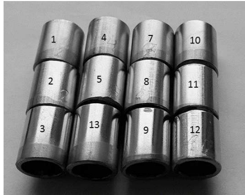
Рисунок 2 - Внешний вид образцов после обработки при следующих режимах обработки: коэффициент заполнения – 25%, соотношение амплитуд положительного и отрицательного импульсов - 33%; период следования импульсов – образцы 1-3 -40 мкс, плотность тока 1,2,3 А/см 2 соответственно, образцы 4,5,13 - 80 мкс, плотность тока 1,2,3 А/см 2 соответственно, образцы 7-9 -160 мкс, плотность тока 1,2,3 А/см 2 соответственно, образцы 10-12 -320 мкс, плотность тока 1,2,3 А/см 2 соответственно
