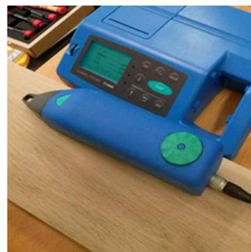
Рисунок 1 – Профилограф HOMMEL TESTER T1000 basic
