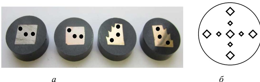
**Рисунок 2 – Схема размещения сеток индентирования на запрессованных в смолу образцах (а) (слева направо: Без покрытия (БП), АТ72, ТК13, ТК12) и схема индентирования в пределах отдельной области образца (б)**
