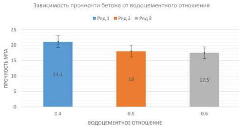
**Рисунок 2 - Зависимость прочности бетона от водо-цементного отношения**
