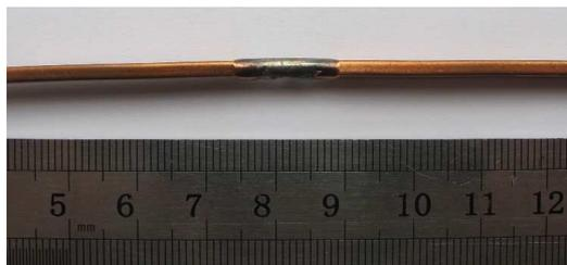
Рисунок 2 – Внешний вид сварного соединения ЭЛС
