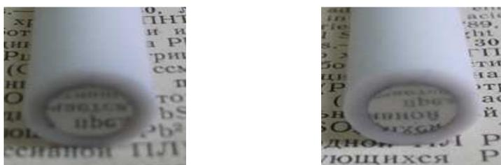
**Рисунок 1 - Внешний вид образца из стали Ст25Х3М3НБЦА после обработки в фосфорносернохромовокислом электролите (а) и в электролите с добавкой триэтаноламина (б) при температуре 70°С**
