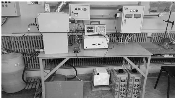
**Рисунок 1 – Фотография экспериментальной установки импульсной электрохимической обработки**
