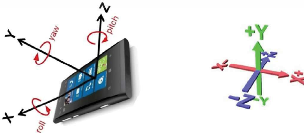
Рисунок 4 – Системы координат смартфона и в среде Unity
