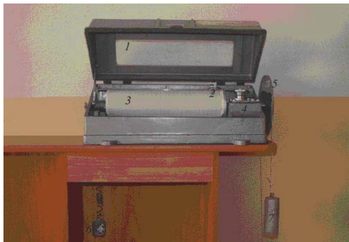
Рис. 8. Самописец уровня воды «Валдай»: 1 – крышка; 2 – каретка с пером; 3 – барабан с лентой; 4 – часовой механизм; 5 – шкив с тросом; 6 – гирька часового механизма; 7 – противовес поплавок для натяжения троса
