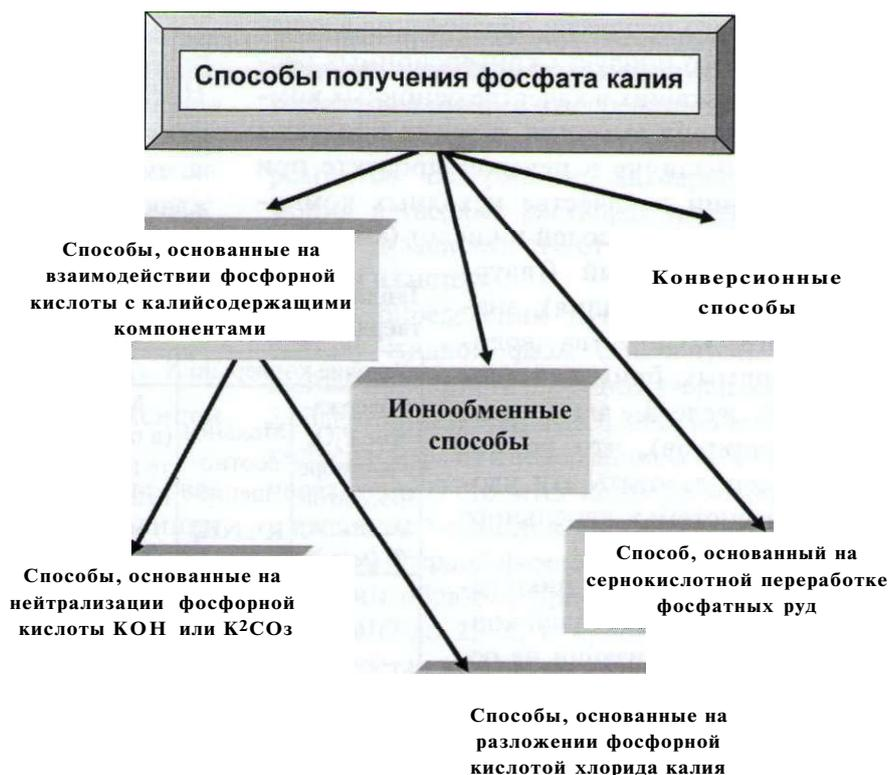
Рис. 1. Классификация способов получения фосфата калия
