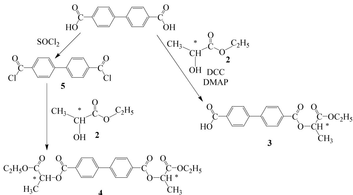
Поставленная задача была решена применением различных реагентов для проведения получения моно- и бис- эфиров. Для синтеза моноэфира 4,4'-дифенилдикарбоновой кислоты была использована реакция этерификации по Стеглиху. Для получения бисэфира **4** исходную кислоту **1** предварительно перевели в её хлорангидрид **5**, к которому добавили этил-L-лактат **2**. Строение всех синтезированных соединений подтверждено данными ПМР- и ИК-спектроскопии.
