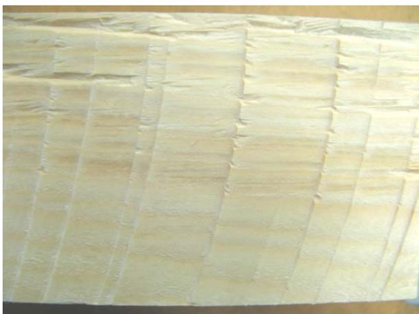
Рис. 5. Качество поверхности пласти бруса из древесины ели при  $a = -25$  мм
