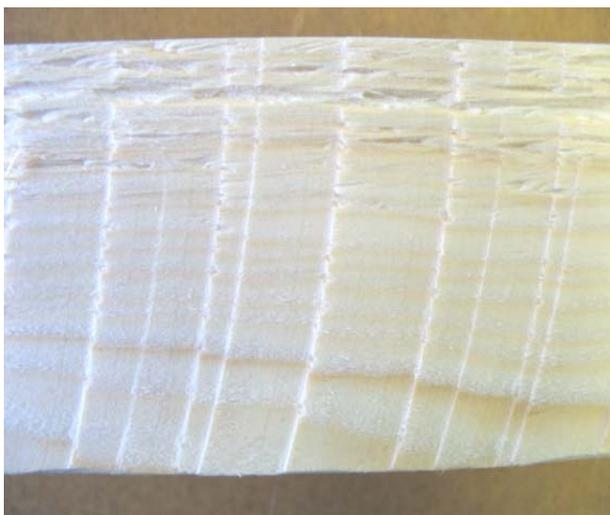
Рис. 4. Качество поверхности пласти бруса из древесины ели при  $a = 0$  мм
