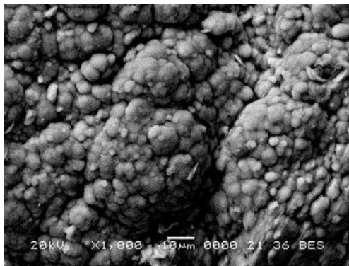
Рис. 4. Фрактограмма частиц серой фазы с рельефом "зигзаг крапчатый". Образец Эфс-17, СЭМ
