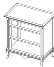
Рисунок 2 – Каркас комода спроектированного в среде многотельной детали
