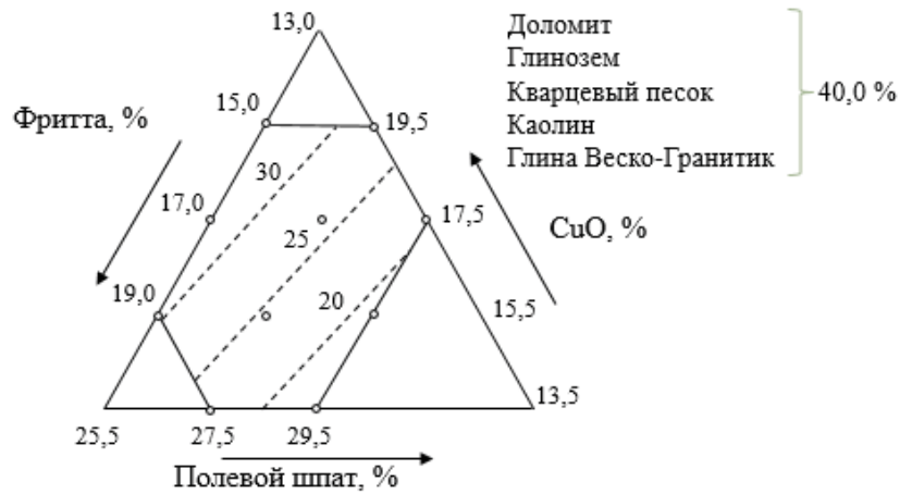
Рисунок 1 – Линии равных значений блеска (%) глазурей
