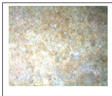
Рисунок 2 – Оптическая микроскопия поверхности излома образцов керамики, обожженных при 1450 °С на основе гиббсита (×100)
