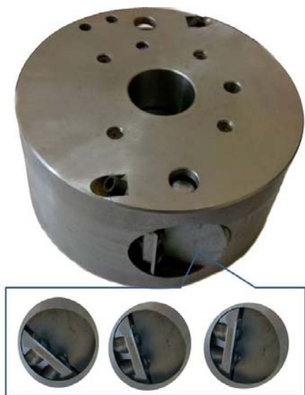
Рис. 3. Натурный образец фрезы сборной с адаптивными свойствами
