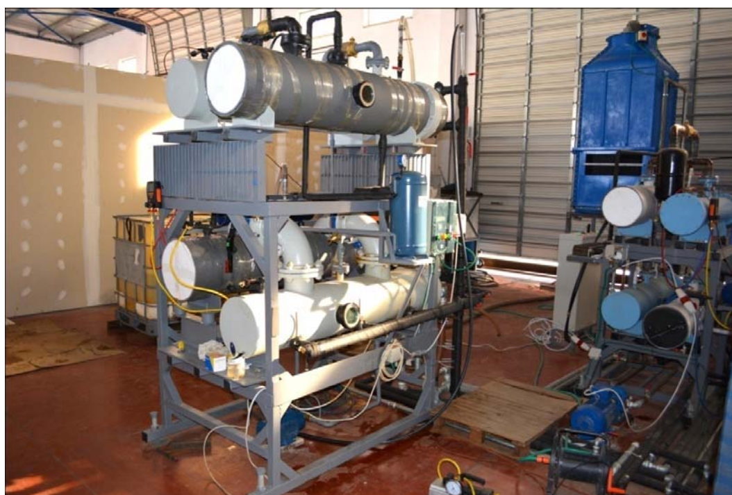
Рис. 6. Пилотный вариант АБХМ с рабочим раствором LiBr / CH 3 OH
