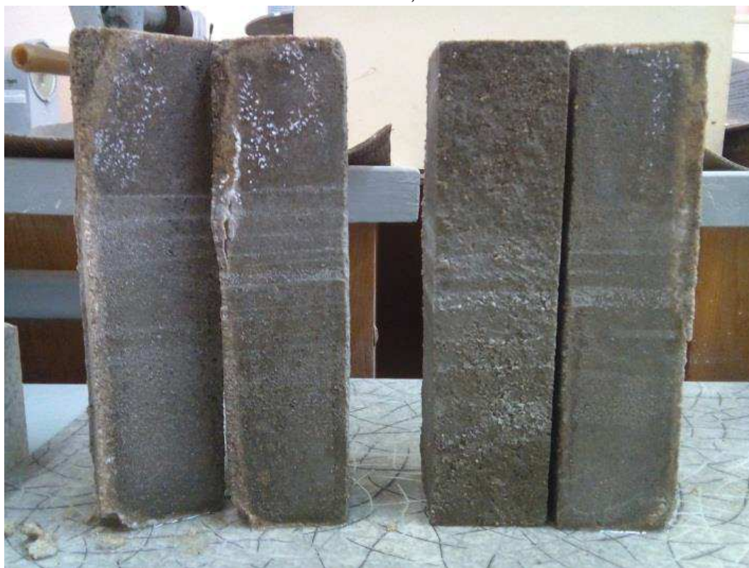
Рисунок 1 – Образцы бетона контрольного состава и состава с добавкой трепела (1% от массы цемента)
