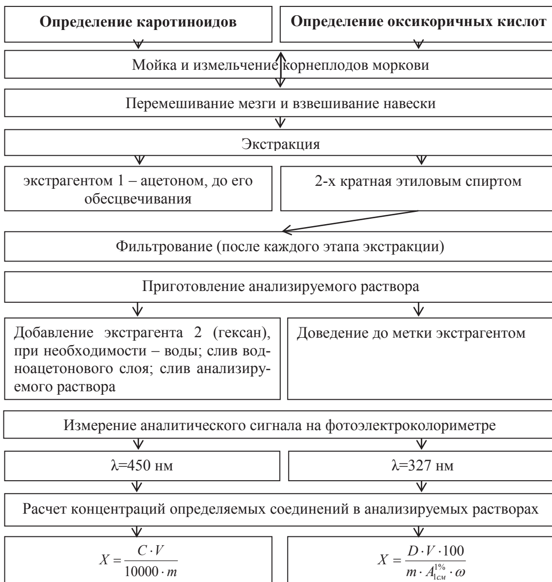
Рисунок 1 – Блок-схема этапов определения каротиноидов и оксикоричных кислот в моркови методом фотометрии
