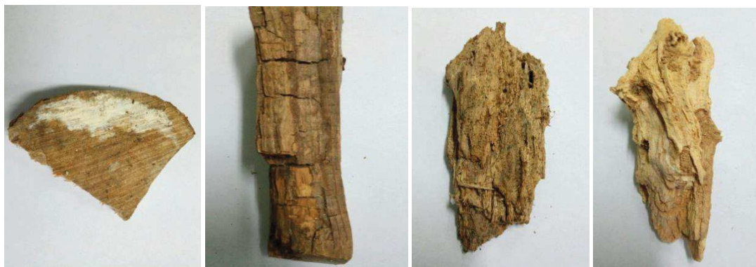
Рисунок 1 – Образцы поврежденной древесины
