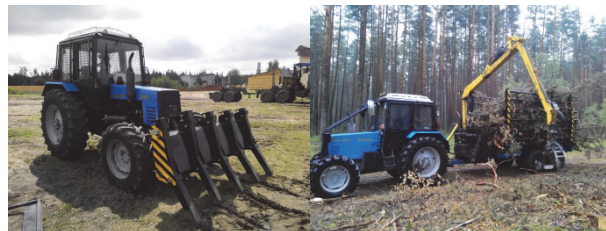
а б Рис. 1. Комплекс машин для сбора и транспортировки лесосечных отходов: а – машина для сбора лесосечных отходов; б – машина для транспортировки лесосечных отходов
