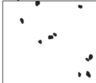
Рисунок 2 - Фотографии частиц вторичного порошка на основе полиамида-12, марки PA2200
