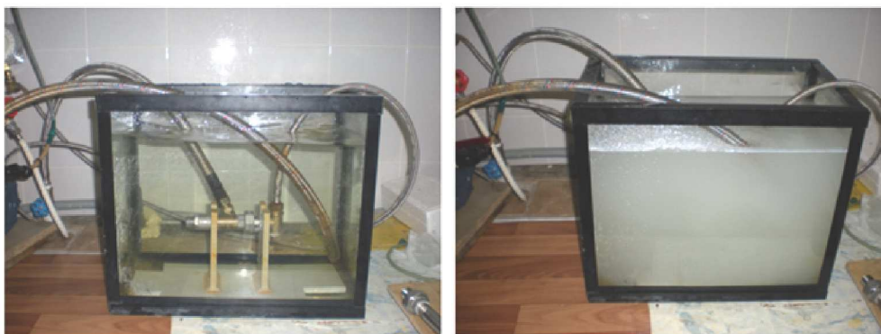
Рисунок 2 – Диспергирование пузырьков воздуха в воде в процессе обработки
