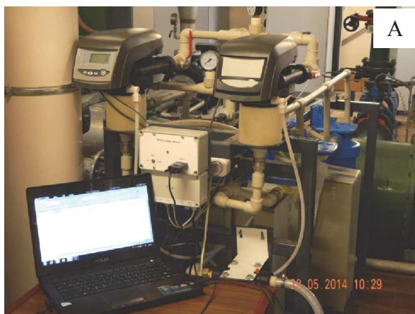
А – вид со стороны системы управления. В – вид со стороны блока ионообменных фильтров Рисунок 1 – Фотография экспериментальной мобильной установки
