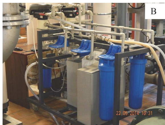
А – вид со стороны системы управления. В – вид со стороны блока ионообменных фильтров Рисунок 1 – Фотография экспериментальной мобильной установки
