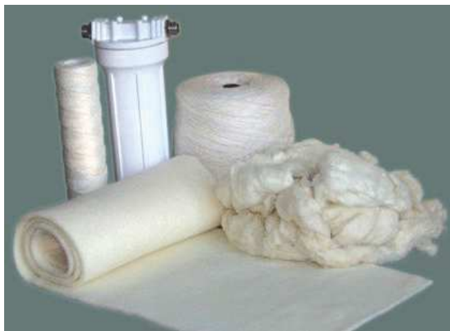
Рисунок 1 – Текстильные формы волокнистого ионита ФИБАН X-1 (штапельное волокно, пряжа и нетканый материал), картридж и фильтр очистки воды
