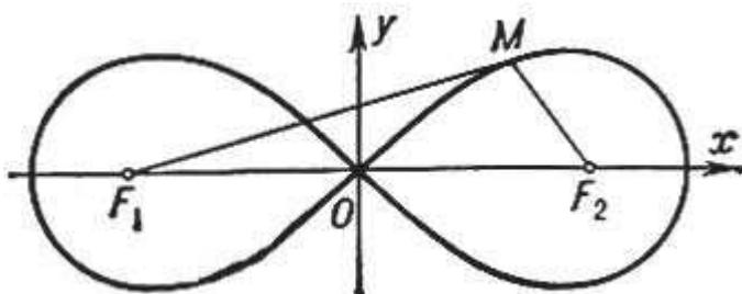
Лемниската Бернулли используется в качестве переходной линии на закруглениях малого радиуса (например, на трамвайных путях).
