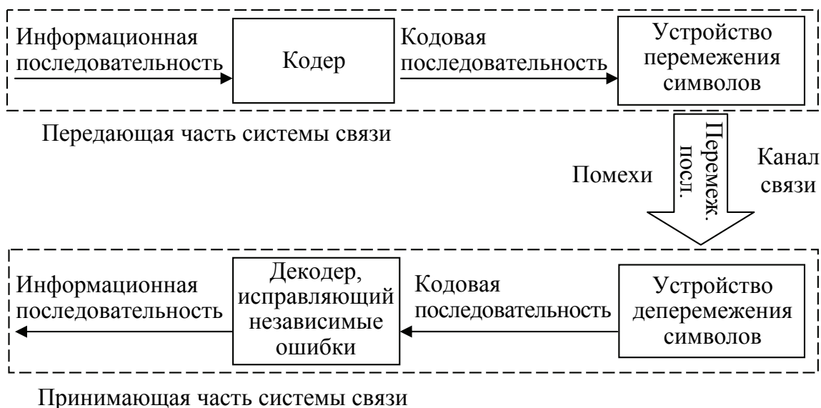
Рис. 6.2. Структурная схема ИС с перемежителем/деперемежителем
