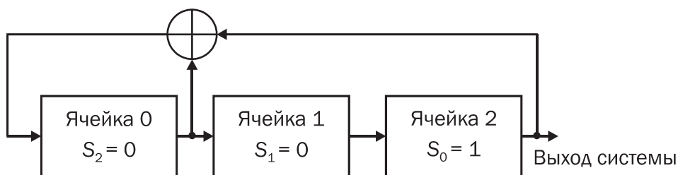
Рис. 6.3. Структурная схема РСЛОС, заданная полиномом C(x) = 1 + c_1 \cdot x + c_3 \cdot x^3
