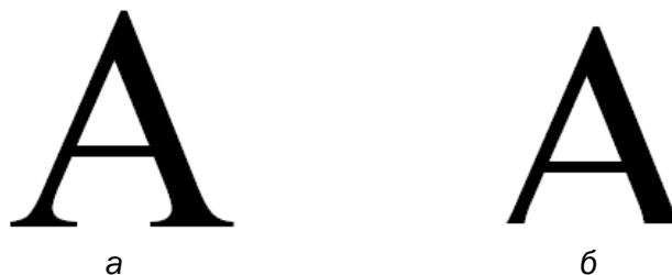
Рис. 7.6. Пример применения метода feature coding : а – пустой контейнер; б – заполненный контейнер (со стегосообщением «1»)
