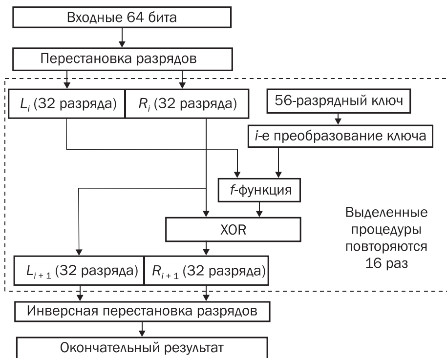
Рис. 5.1. Общая схема алгоритма DES
